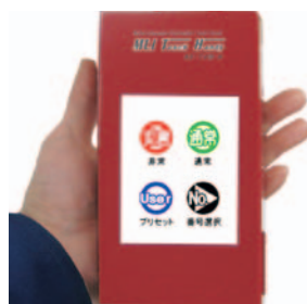
▲MLIタッチハンディ 車載用途のハンディサイズの多言語再生装置。消防車など、放送設備をもつ自動車のスピーカーに接続できる
