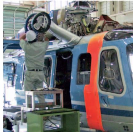
航空隊で点検・整備中の「やまびこ2号」。ヘリは25時間稼働する度に、約1週間の点検が必要。また年1回の耐空検査ではオーバーホールも必須なため、1機で年間約200時間程度の飛行となる
