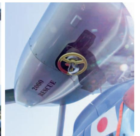
ヘリのドア上部にある銀色の箱はホイスト。なかにある90mのワイヤーを使って遭難者と救助隊員を吊り上げ、ウィンチで巻き上げる
